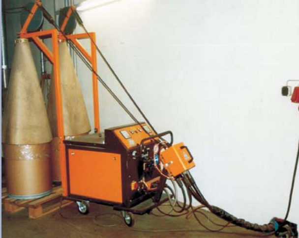
Anlage zum thermischen Verzinken mit einer Kapazität von 30 kg/h mit Schlauchgarnitur ausreichend für 15 m Arbeitsradius
